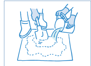
セメントと砂を混ぜて、中央にくぼみをつくり、水を入れます。
